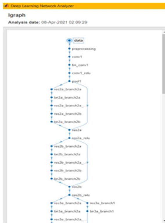
Fig. 2. Arquitectura ResNet-18 con YOLO V2.
